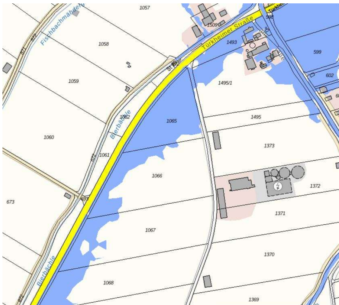
Abbildung 3: Lageplan mit der Hochwassergefahrenfläche HQ 100 der Gennach (Quelle: Bayernatlas, zuletzt abgerufen am 14.12.2022).
